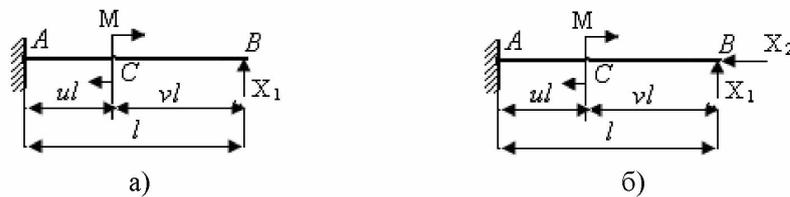
Рис. 7. Схемы однопролетных балок с заменой лишних связей соответствующими реакциями: а) схема балки с заменой шарнирно-подвижной опоры реакцией  $X_1$ ; б) схема балки с заменой шарнирно-неподвижной опоры реакцией  $X_1$  и  $X_2$
