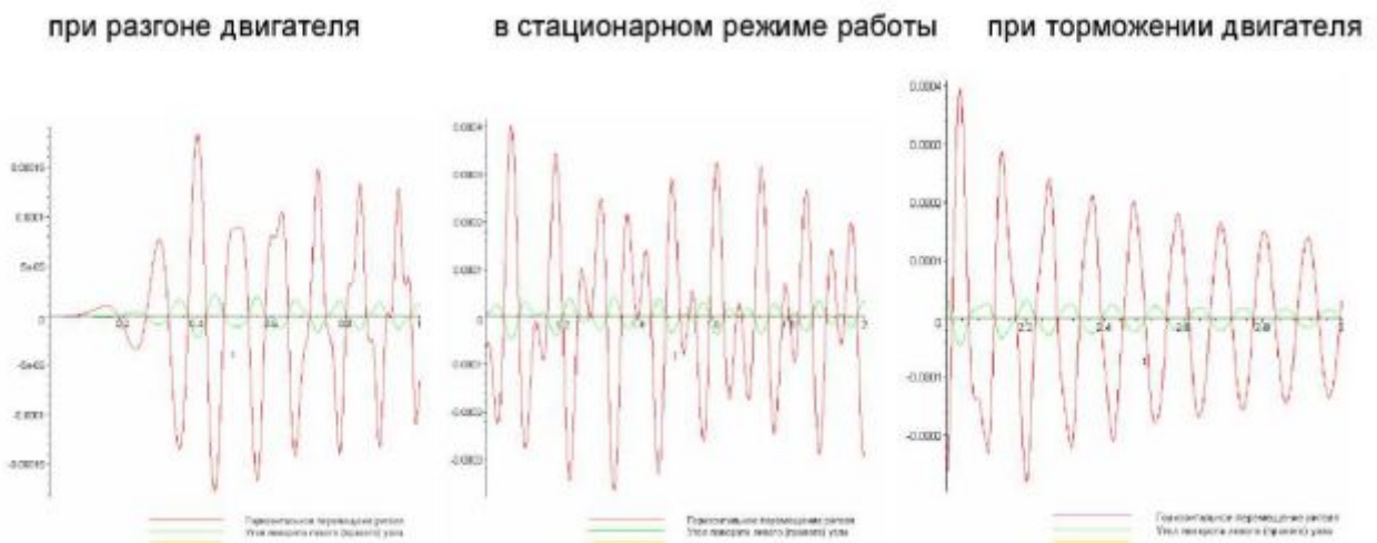
Рис.5.25. Результаты расчета рамы в переходных режимах работы
