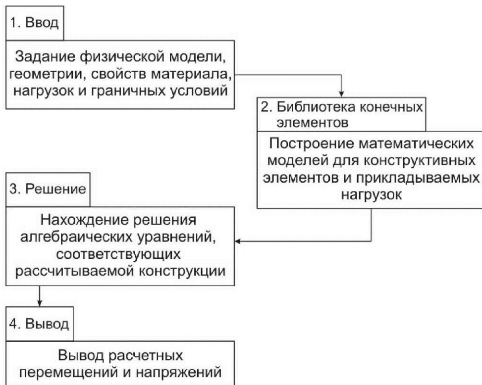
Рис. 4.1. Блок-схема программы общего назначения
