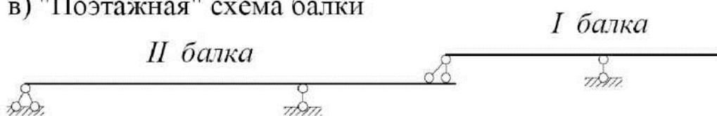
г) Расчетная схема I балки
